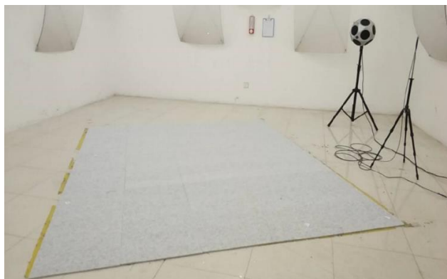
Configuración de Treset: ISO 354:2003 e ISO 11654:1997
